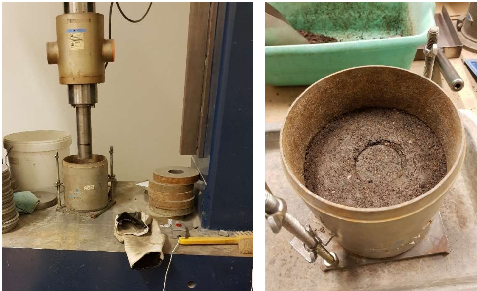
Figur 1. Foto på belastningsutrustning till vänster och provyta efter belastning efter CBR-försök.
