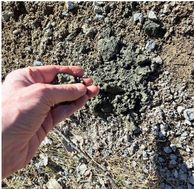
Figur 20. Enstaka fillerklumpar från sträcka 4.
