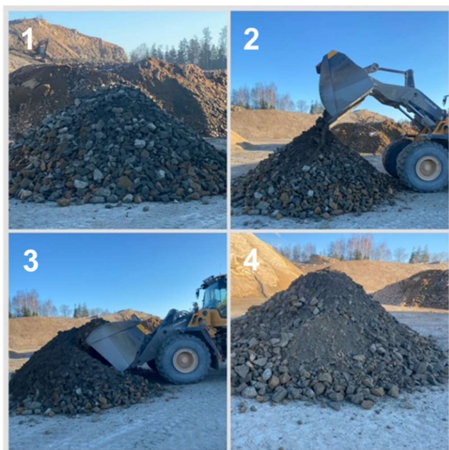
Figur 11. Illustration av inblandning av fuktig filler i sortering 0/150. 1. Oblandat en-stegs krossat 0/150. 2. Filler från asfaltverk fördelades jämt över upplag av 0/150. 3. Homogenisering av materialet genom skopblandning. 4. Homogeniserat material för produktion av grusslitage.
